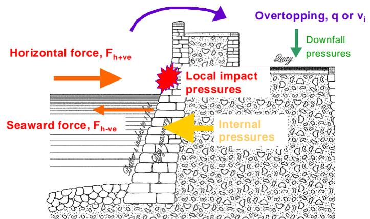
Figure 3—Wave-driven Loadings<sup>1</sup>
